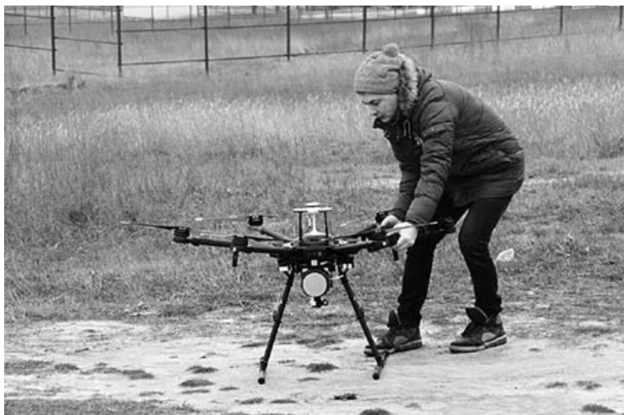
Рис. 4. Гексакоптер Matrice 600 PRO фирмы DJI с полезной нагрузкой в виде воздушного лазерного сканера АГМ-МСЗ
